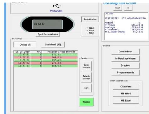
L'usage de ce Teslamètre est principalement réservé aux expertises de mesure de rémanence et d'une façon plus générale des champs magnétiques de toute origine ainsi que pour localiser/mesurer des champs magnétiques de dispersion ou de fuite permettant en outre de dimensionner les fissures dans les matériaux ferromagnétiques
