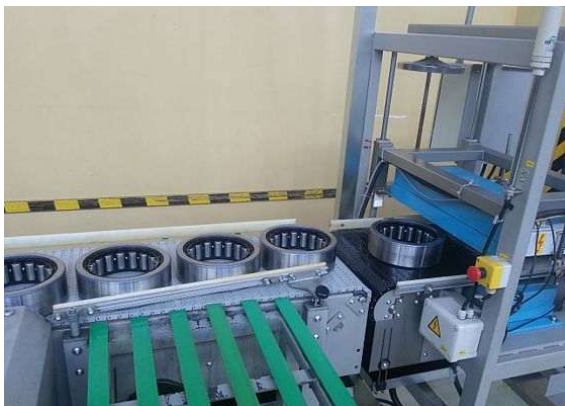
Démagnétiseur pour roulements utilisant deux plateaux démagnétiseurs superposés
