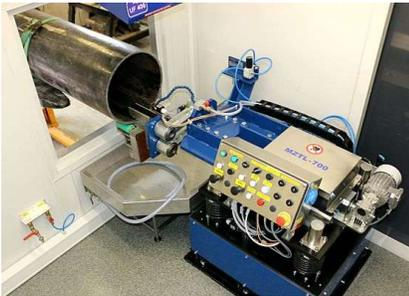
Banc pour le contrôle des extrémités de tube
