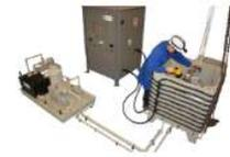
Magnétoscopie sans contact 50 Hz et BF
