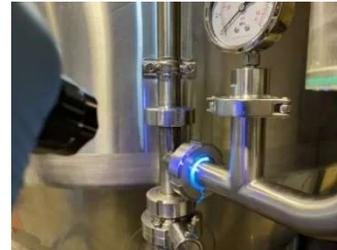
**Puissante torche lumineuse à LED UV-A (365 nm) couplée à un corps de lampe robuste en aluminium durable, résistant à l'eau et aux chocs, conforme aux spécifications ASTM en matière d'intensité et de longueur d'onde des UV-A.**
