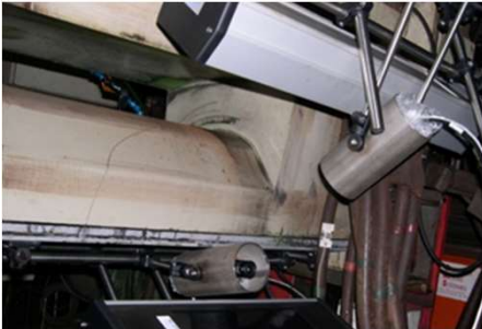
Contrôle magnétique d'extrémités de tubes et chanfreins avec système de vision intégré
