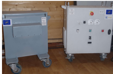
Générateur de courant modulaire : Module pilotage, et module transformateur à part.
