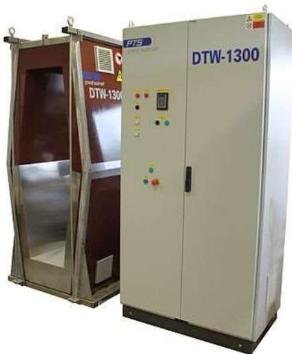
Démagnétiseur de roues pour le ferroviaire
