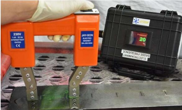
❖ **Electroaimant basse fréquence 10 Hz autonome avec son alimentation sur batterie de fabrication IXTREM**
