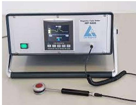
Cet équipement dispose d'une interface RS 232 et USB de communication PC et d'un écran tactile interactif permettant d'accéder aux menus et de visualiser les courbes d'acquisition de façon autonome.
