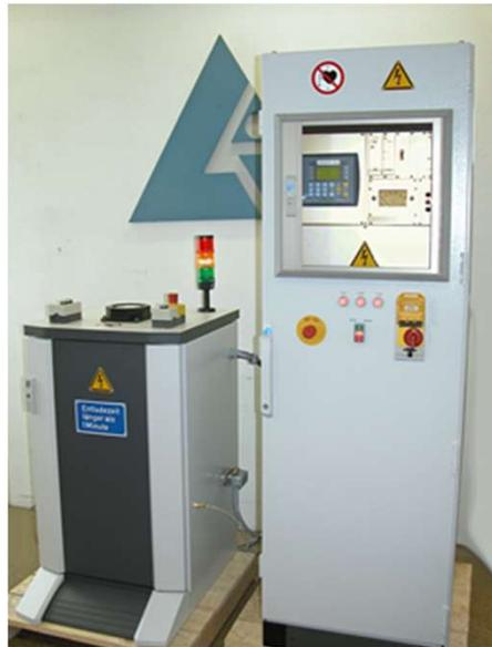
Les magnétiseurs de la série UKI-MPLC fonctionnent conformément à la méthode de décharge de condensateurs contrôlés par PLC. Ils sont utilisés dans l'aimantation multipolaire de tous les types de systèmes à aimants permanents, et, plus particulièrement, pour l'aimantation des aimants permanents à terres rares.
