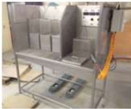
Stations de ressuage et de traitement des eaux usées
