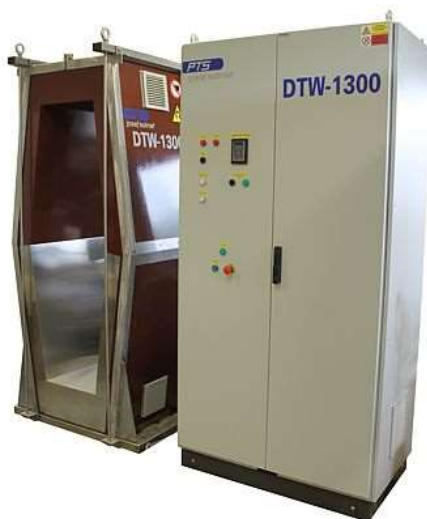
Démagnétiseur de roues pour le ferroviaire
