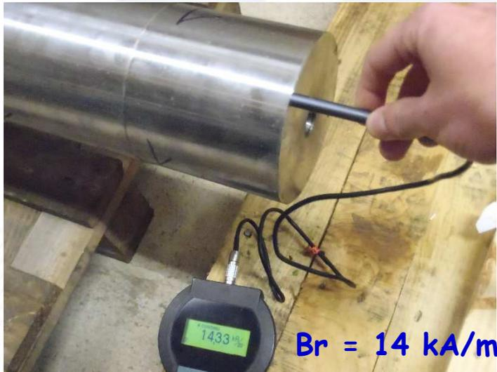
*Démagnétisation par enroulement*
