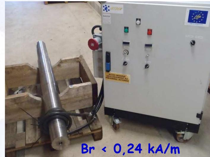
→ La profondeur de pénétration des lignes de champs magnétiques à basse fréquence permet de réaliser des désaimantations complètes des pièces aéronautiques, nucléaires et ferroviaires et de descendre à des valeurs de rémanence magnétique B inférieure à 240 A/m.
