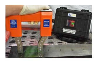
**\*** Electroaimant basse fréquence 10 Hz autonome avec son alimentation sur batterie de fabrication IXTREM
