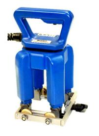
Distance entre pôles 140 x 140 mm Dimensions des pôles 25 x 25 mm Encombrement approx. 210 x 220 x 330 mm Force de levage > 250 N Alimentation 42V 50Hz 2 x 42 V AC Intensité de courant 2 x 13 A Facteur de marche 60 % Poids 9.8 kg Longueur de câble 5 m IP <u>54</u> Degré de protection
