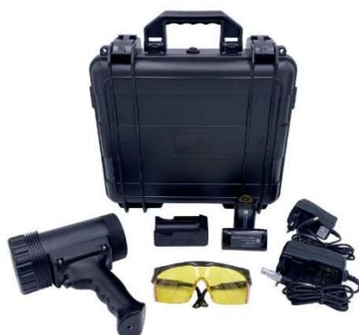
Léger (600gr), compact et puissant, ce projecteur pistolet UV offre une zone de couverture UV 365 nm de 25 à 38 cm, avec une intensité UV jusqu'à  $4000 \mu\text{W}/\text{cm}^2$ , idéal pour réaliser des diagnostics sur de grandes surfaces en CND et tests d'étanchéité.
