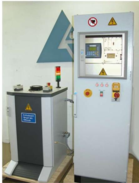
Les magnétiseurs de la série UKI-MPLC fonctionnent conformément à la méthode de décharge de condensateurs contrôlés par PLC. Ils sont utilisés dans l'aimantation multipolaire de tous les types de systèmes à aimants permanents, et, plus particulièrement, pour l'aimantation des aimants permanents à terres rares.
