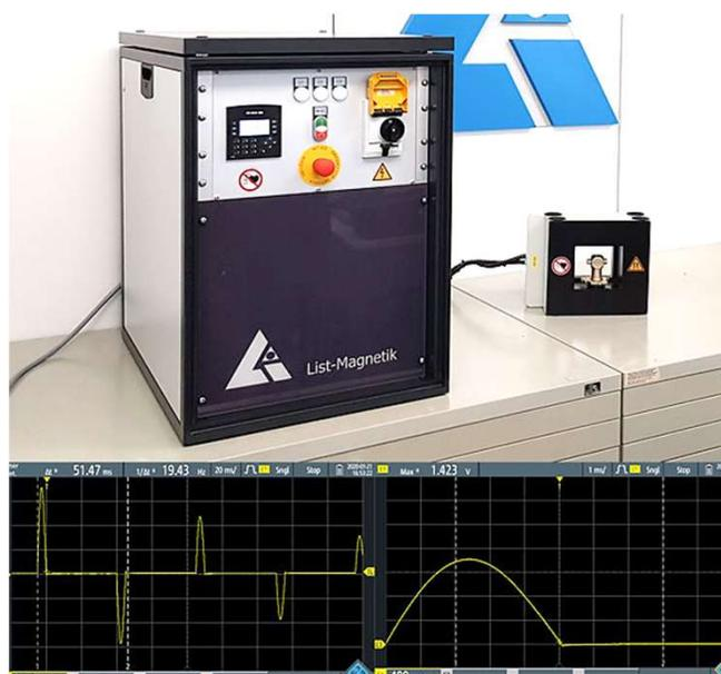
Efficace et puissant, grâce au processus de décharge de condensateurs piloté par PLC, ce moyen d'aimantation et de démagnétisation est un dispositif particulièrement performant, d'un coût très modéré et bien adapté aux aimants et aux systèmes de capteurs en ferrite ou en alliage AlNiCo.
