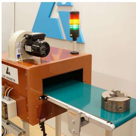
**L'équipement IX-LM/DEMAG -500 peut également être utilisé en mode démagnétisation**
