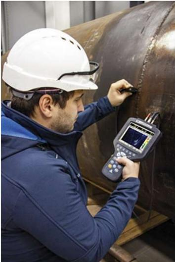
Le tomographe-détecteur de défauts à ultrasons portable universel avec la technologie TFM (Total Focusing Method) visualise la structure interne de l'objet sous forme d'imagerie en coupe en temps réel (B-Scan), ce qui rend l'interprétation des résultats beaucoup plus facile qu'avec un détecteur de défauts traditionnel.
