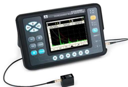
Version classique d'appareil ultrasons facile et pratique d'utilisation qui dispose d'une commande vocale pour les commentaires des A scan stockés par Bluetooth.
